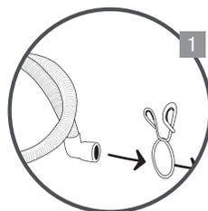
Conecte la abrazadera a la manguera para prevenir el derrame de agua.
