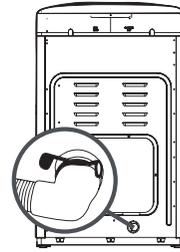
En la parte trasera de la lavadora se encuentra la salida de la bomba del desagüe.
