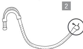
Luego conecta el codo de la manguera dentro de la salida de la bomba como muestra el dibujo.
